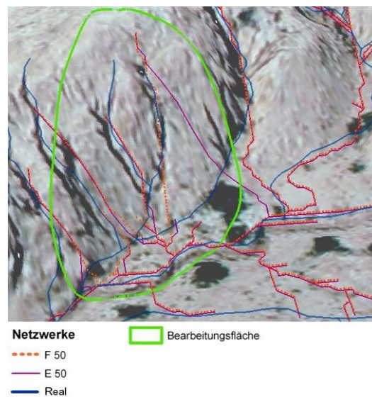
Abb. 78: Bearbeitungsfläche F: Der Rinnenverlauf (F 50) konnte im Vergleich zum alten Verlauf (E 50) verbessert werden. Vergleicht man den verbesserten Verlauf mit dem realen (hellblau) sieht man, dass diese größtenteils übereinstimmen ( Screenshot aus ArcScene, zweifach überhöht).
