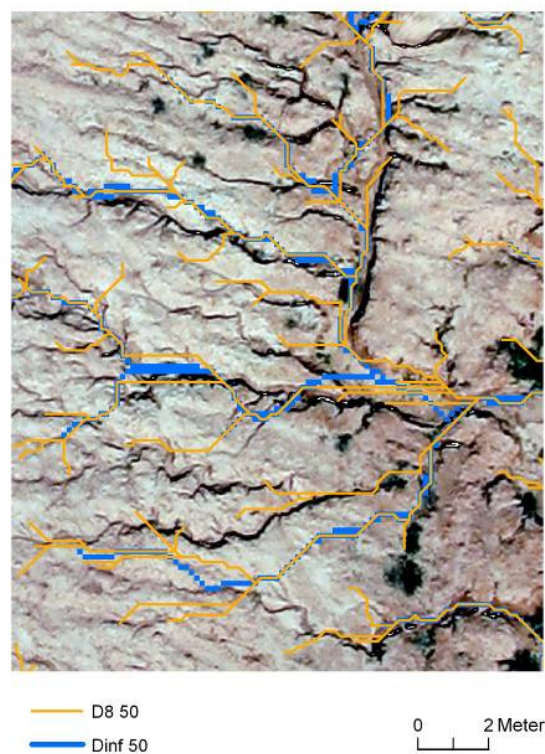
Abb. 72: Die für den D8-Algorithmus typische Ausbildung paralleler Fließpfade wird auf diesem Ausschnitt deutlich (Basis DGM B).
